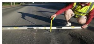
Рис. 1. – Схема измерения колеи рейкой
