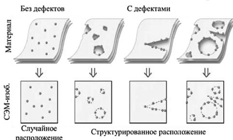
Рис. 1. Иллюстрация идеи анализа качества поверхности материала на основе структурированного расположения наночастиц
