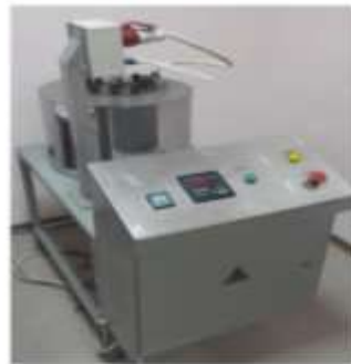
Рисунок 3. Лабораторная установка для экстрагирования сверхкритической водой
