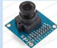
Модуль камеры OV7670 для Arduino
